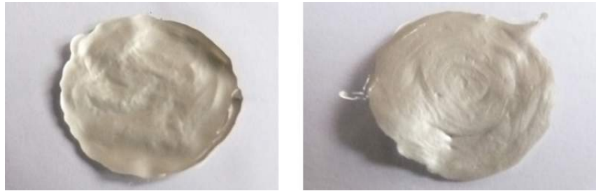
Abbildung 5.13: Horizontalschrumpf der untersuchten Leitklebstoffe; links: ICA A; rechts: ICA B
