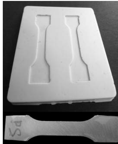
Abbildung 3.4: Herstellungform und fertige Probe eines Leitklebstoffes zur Untersuchung der Zugstabilität
