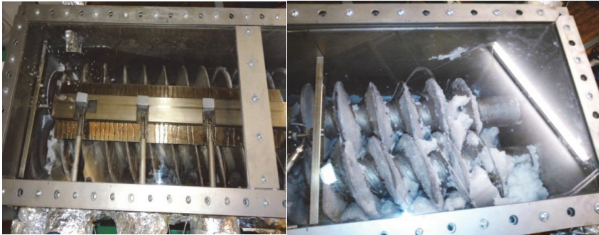
Abbildung 22: Linke Bildhälfte: Verbesserung des Schmelzeinlasses durch Einbau einer Verteilrinne (Zone 1). Rechte Bildhälfte: Auslaufzone im SWÜ zur Erhöhung des kristallisierten Anteils am Auslass (Zone 2). Die Förderrichtung ist im Bild von links nach rechts.
