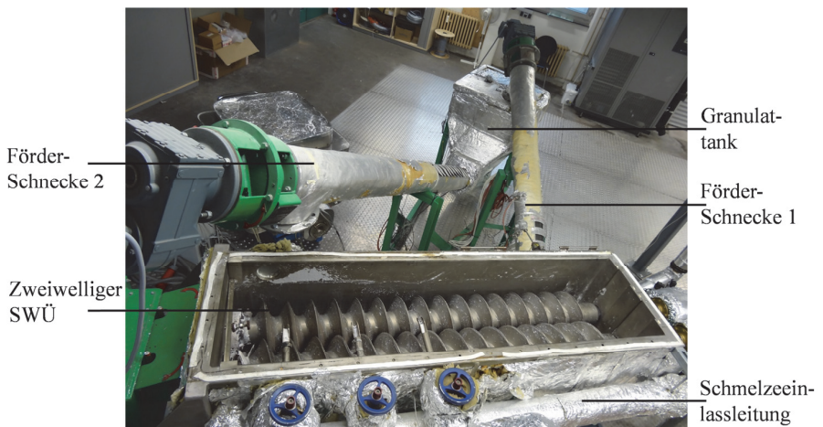
Abbildung 13: Draufsicht auf den PCM-Transportkreislauf mit Schneckenwärmeübertrager, zwei Förderschnecken und Granulattank
