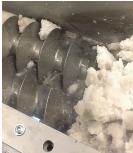
Abbildung 20: Anhäufung von granulearem PCM am Ende des Schneckenwärmeübertragers während des Schmelzens (rechts im Bild)
