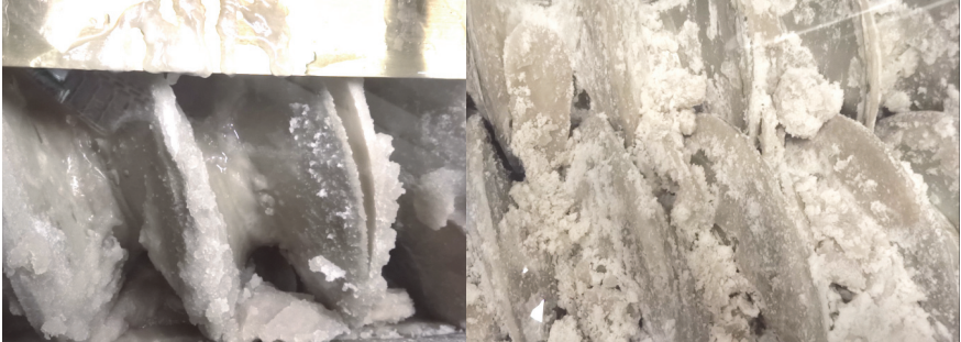
Abbildung 66: Detailaufnahmen: Links: Schmelzeinlassbereich mit Verteilrinne (oberes Bildviertel) und einer Welle mit aufkristallisierter PCM-Schicht; am rechten Flügel platzt ein Teil der PCM-Schicht ab; Rechts: Bereich, in dem vollständig kristallisiert wird. Intensiveres weiß ist ein Indikator für eine vollständige Kristallisation. Die graueren Bereiche sind noch nicht vollständig erstarrt.
