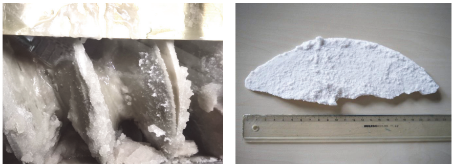
Abbildung 36: Links: Abplatzen einer PCM-Schale während des Kristallisierversuchs. Rechts: Abgeplatzte PCM-Schale.
