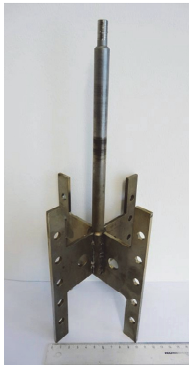
Abbildung 69: Für die ausgewerteten Versuche am Kratzwärmeübertrager verwendeter Rührer
