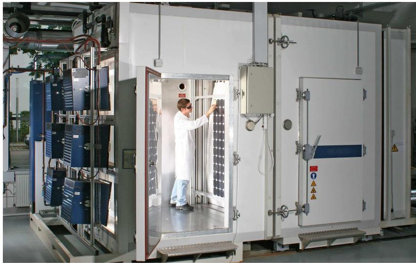
Abbildung 4.1: Die IU-Kennlinien der betrachteten Dünnschicht PV-Module wurden in einer Klimakammer mit einem Solarsimulator der Klasse B gemessen
