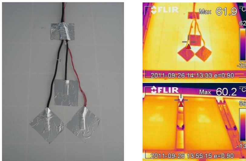
Abbildung 3.5: Zur genauen Messung der Modultemperatur wurden an verschiedenen Punkten der PV-Module PT100 Sensoren angebracht. Die linke Grafik zeigt dazu die Anbringung der PT100 Sensoren an einem c-Si Referenzmodul. Dabei sind zwei Sensoren in der Mitte einer Zelle, ein Sensor zwischen zwei Zellen jeweils im Mittelbereich des Moduls angebracht. Die rechten Grafiken zeigen die dazu aufgenommenen Infrarotbilder von der Rückseite (rechts oben) und der Vorderseite (rechts unten) des Moduls
