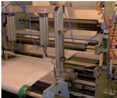
(d) Thermo-mechanical welding bar [8]
