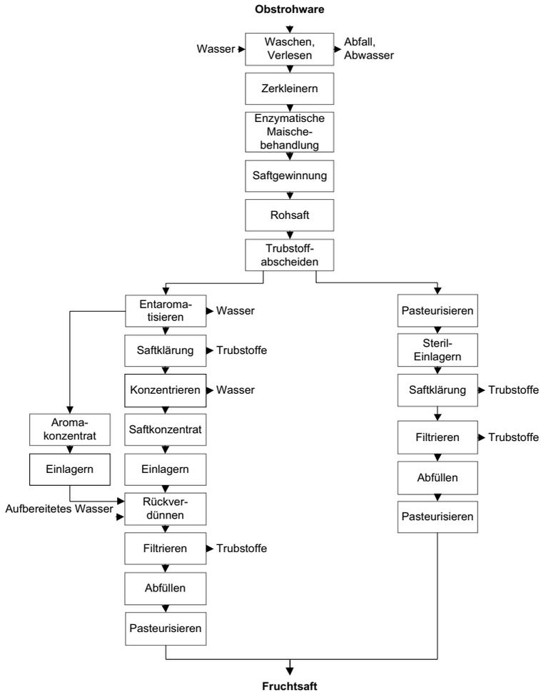
Abbildung 8-3: Grundfließbild der Herstellung von geklärtem Fruchtsaft nach Tschuschner (2004)
