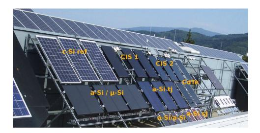
Abbildung 3.2: Aufbau der im Rahmen dieser Arbeit betrachteten Außenbewitterungen in Freiburg. Die PV-Module sind dabei in Richtung Süden bei einer Neigung von  $n=45^\circ$  exponiert. Die geografische Breite des Ortes ist  $b=48,009^\circ$ , die geografische Länge  $l=7,835^\circ$
