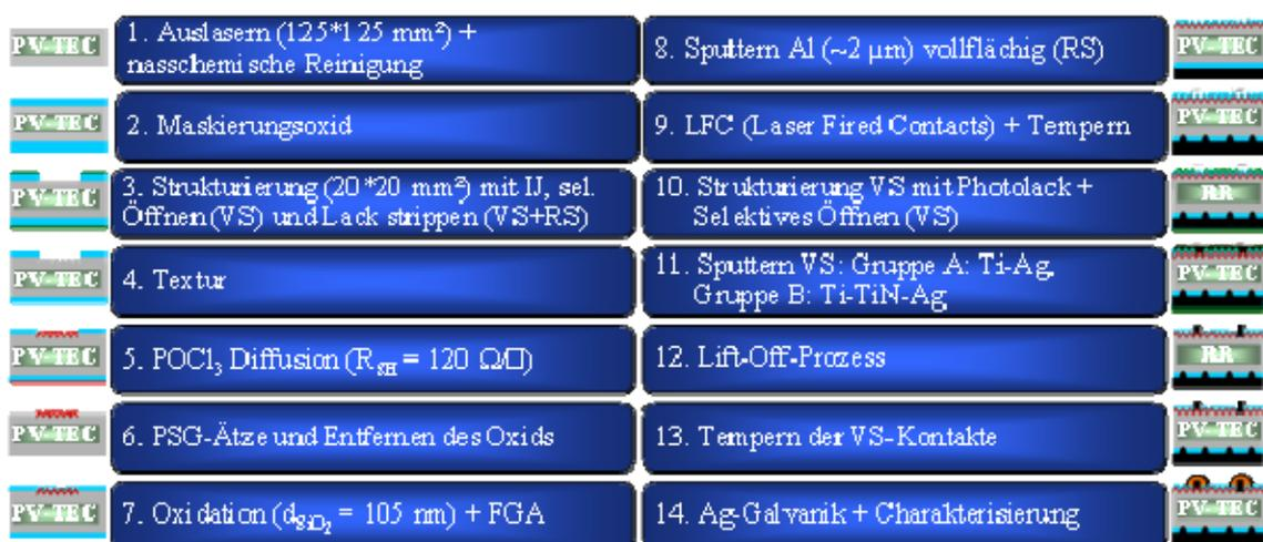
Abbildung 5.1: Prozessübersicht zur Herstellung hocheffizienter Solarzellen.
